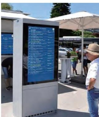
屋外用の防水防塵の筐体に組み込んで屋外に設置される場合も同様に日差しの角度をご確認下さい。直射日光の強度は視認性のみならず、筐体内の温度上昇にも大きく影響してきます。ディスプレイは超高輝度タイプが適切な選択と言えます。
